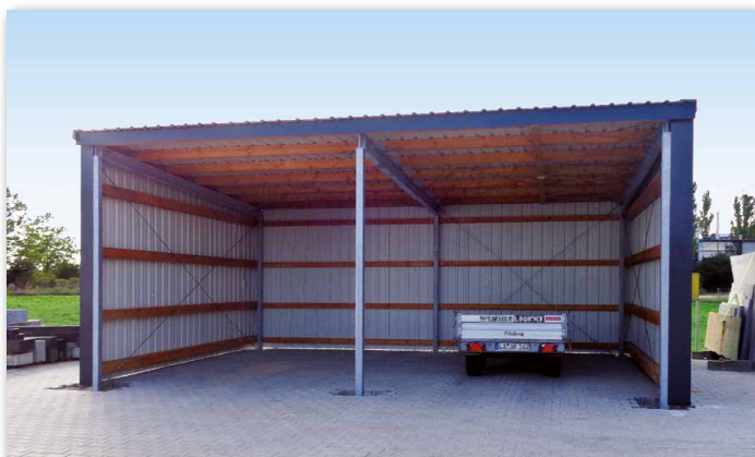
Halle Typ PD3 - 10,00m Breite (2 Felder á 5,00m), 6,00m Tiefe, Farbe anthrazitgrau (ähnl. RAL 7016)
